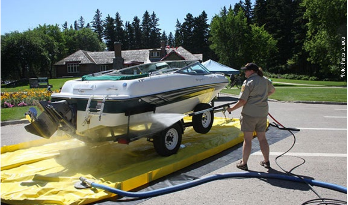
Utilisation d'une membrane de récupération d'eau de nettoyage à une station de décontamination d'embarcation.
